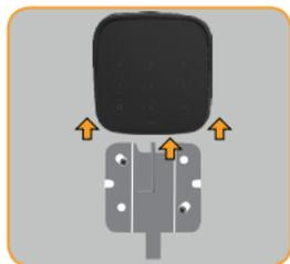
Svitare il dispositivo e farlo scorrere lungo il supporto a muro
