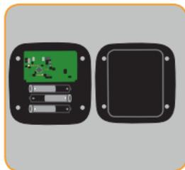
Sostituire le batterie (3x AAA 1,5 Vdc )
