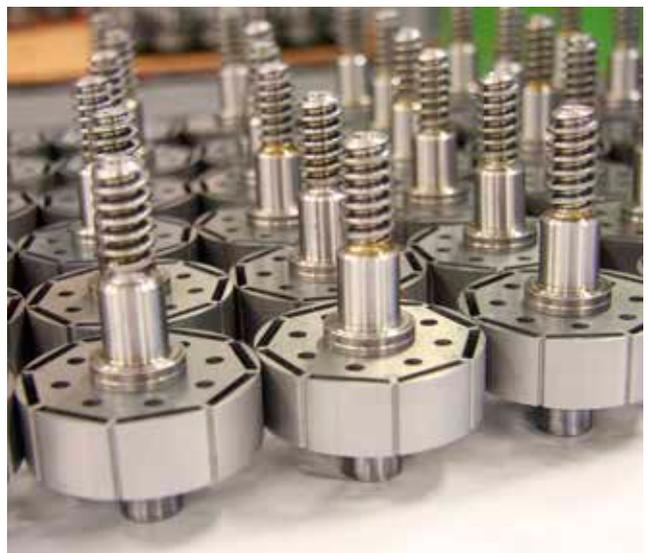
Un motore digitale senza spazzole a campo magnetico permanente, con un'elettronica digitale per un totale e sicuro controllo dell'automazione, e per un uso super intensivo a consumi estremamente ridotti:
